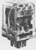
Relè standard di media potenza. Contatti: argento. Corrente max sui contatti: 10 A. Tensione max sui contatti: 250 V c.c.-c.a. Potenza di eccitazione: 1,2 W in c.c., 2,5 VA in c.a. Potenza di commutazione: 1000 W. con attacchi a spina octal-undecal.
