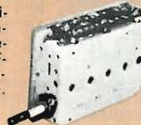
**Gruppo Varicap «Spring» Mod. 16-109.** Media frequenza: 36 MHz. Impedenza 75  $\Omega$ . Demiscelatore incorporato.
