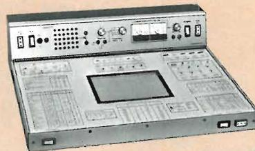
**Tavolo da laboratorio portatile Mod. Pigno 75.** Comprende un alimentatore stabilizzato regolabile da 3  $\pm$  14 V. Carico: 2,5 A. Un altoparlante da 3 W 5  $\Omega$ . Un generatore B.F. frequenze fisse 200 - 400
