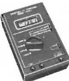
**Tester digitale «Hioki» Mod. 3201.** Display a cristalli liquidi. Circuiti integrati. Campi di misura e portate: Tensione c.c.: 200 mV - 2.000 mV, 20 V - 200 V, 200 V - 1.000 V. Tensione c.a.: 200 mV - 2.000 mV, 20 - 200 V, 200 - 500 V. Corrente c.c. e c.a.: 200  $\mu$ A - 2000  $\mu$ A, 20 mA - 200 mA. Resistenza: 2 k $\Omega$  - 20 k $\Omega$ , 200 k $\Omega$ . Alimentazione: 4 pile da 1,5 V, pila TS/2106-00
