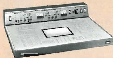
**Tavolo da laboratorio portatile Mod. Pulsar.** Comprende due tipi di alimentazione stabilizzata da 5  $\pm$  20 V negativa e 5  $\pm$  20 V positiva. Carico: 0,6 A. Un generatore B.F. ad impulsi da 0-1 sec. Due prese di servizio da 250 V - 6 A. Piano luminoso da 19x14 cm per osservare i circuiti stampati per trasparenza. Interruttore generale sotto fusibile. Dimensioni: 70x565x150. Dimensioni utili piano di lavoro: 690x445.
