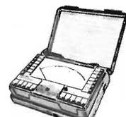
**Novo Test «Cassinelli» Mod. TS 161.** Sensibilità: c.c.: 40.000  $\Omega$ /V - c.a. 4.000  $\Omega$ /V. Portate raddoppiabili:\*. Campi di misura e portate. Tensioni c.c.: 0,15\* - 1\* - 1,5 - 5\* - 30\* - 50\* - 250\* - 1.000 V. Tensioni c.a.: 1,5 - 15\* - 50\* - 300\* - 500\* - 5\* mA - 50\* mA - 500\* mA - 5\* A. Correnti c.c.: 250  $\mu$ A - 50 mA - 500 mA - 5 A. Capacità: 0-0,5 - 0-50 - 0-500 - 0-5.000  $\mu$ F.
