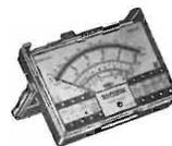
**Tester «Cassinelli» Mod. Euro Test TS 210.** Sensibilità: 20.000  $\Omega$ /V. Campi di misura e portate. Tensioni c.c.: 100 mV-2-10-50-200-1000 V. Tensioni c.a.: 10-50-250-1000 V-2,5 kV. Correnti c.c.: 50  $\mu$ A-0,5-5-50 mA-2 A. Correnti c.a.: 1,5-15-150 mA-6 A. Dimensioni: 138x106x42.
