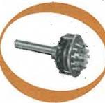
Commutatori rotativi. Per AF. Portata: 0,3 A - 125 Vc.a. Resistenza di contatto iniziale <10 mΩ. Rigidità dielettrica: 1400 Vc.a. Contatti: bronzo fosforoso argentato. Settori: 1 in bachelite Angolo tra due posizioni: 30°. Numero max di posizioni: 12.
